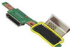
10. Levante los sujetadores y desconecte el cable de la placa de acoplamiento de ésta misma.
