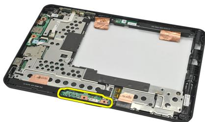
9. Despegue la cinta de la placa de acoplamiento.
