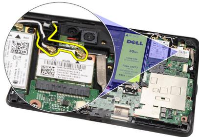
6. Extraiga el tornillo que fija la tarjeta WLAN.
