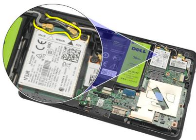
6. Extraiga el tornillo que fija la tarjeta WWAN.
