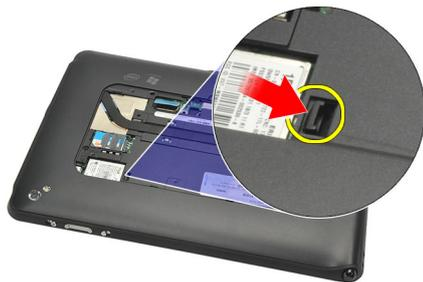
5. Desprenda y libere las lengüetas que fijan la cubierta inferior siguiendo la secuencia de flechas en el esquema.
