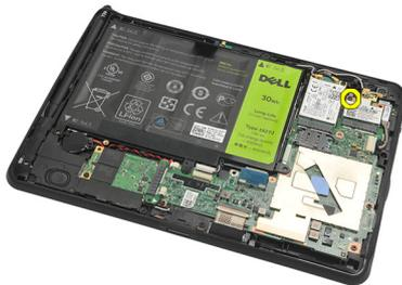
7. Extraiga la tarjeta WLAN del equipo.
