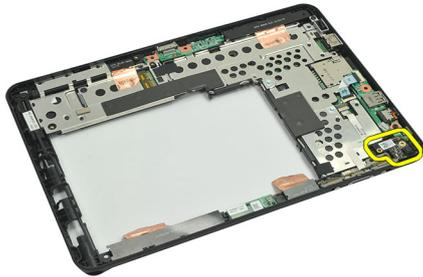
12. Desconecte el cable de la cámara de su placa.
