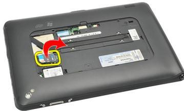
5. Saque la tarjeta SIM de su sujetador y retírela del equipo.
