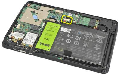
5. Extraiga los tornillos que fijan la batería al equipo.
