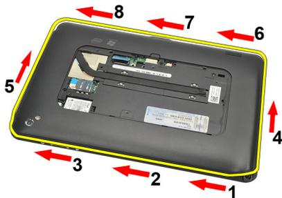
6. Extraiga la cubierta inferior del equipo.
