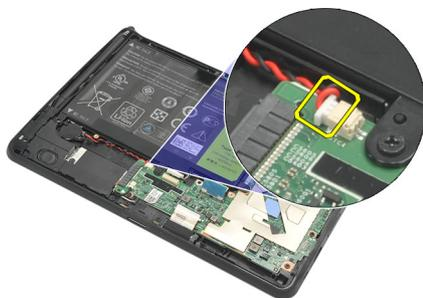
7. Libere el cable de la batería de tipo botón y retire su batería del equipo.
