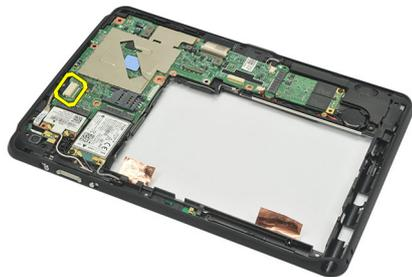
8. Despegue el adhesivo que fija el cable de la cámara a la placa base.
