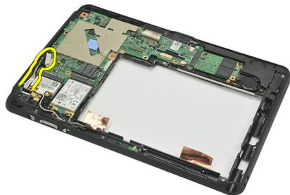
9. Dele la vuelta al ensamblaje del marco intermedio y desconecte el cable LED de la cámara.
