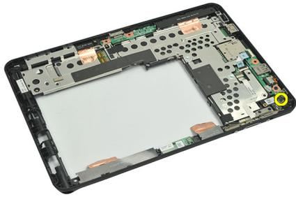
11. Levante la placa de la cámara y retírela del equipo.
